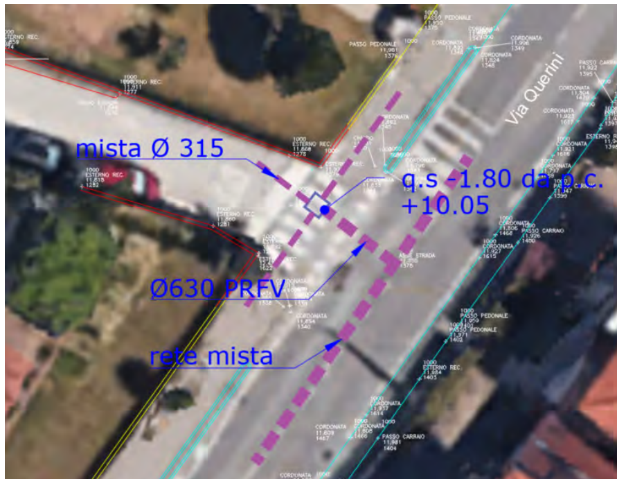
Figura 12: rilievo della rete mista esistente in via Querini
